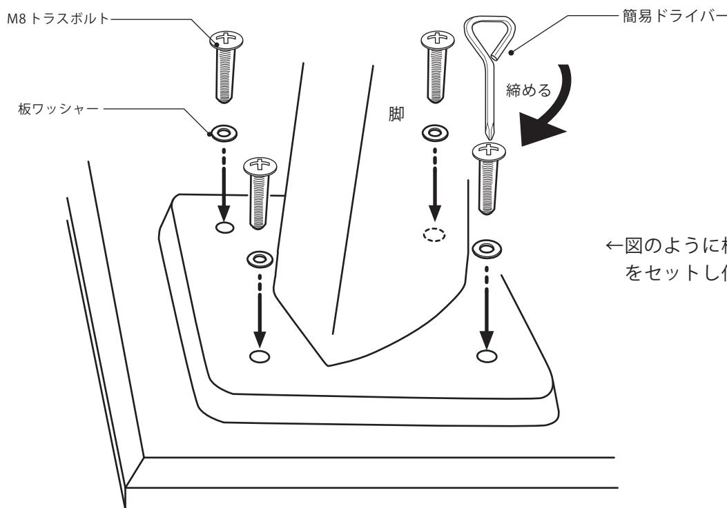
←図のように板ワッシャーをセットし付属の簡易ドライバーで締めてください。
